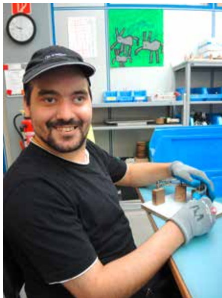
GESCHICKT: Mit einer speziellen Vorrichtung baut Metin Ürentoyu die Schellen zusammen.
